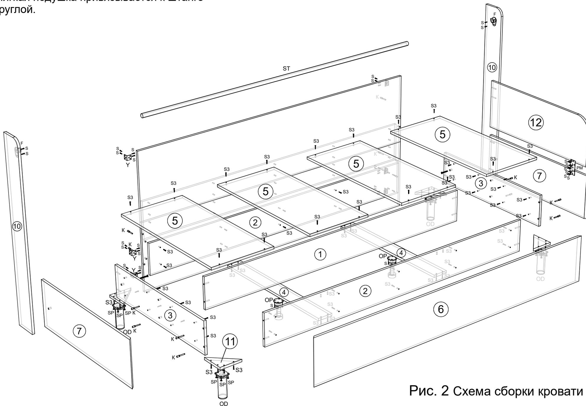
Рис. 2 Схема сборки кровати
