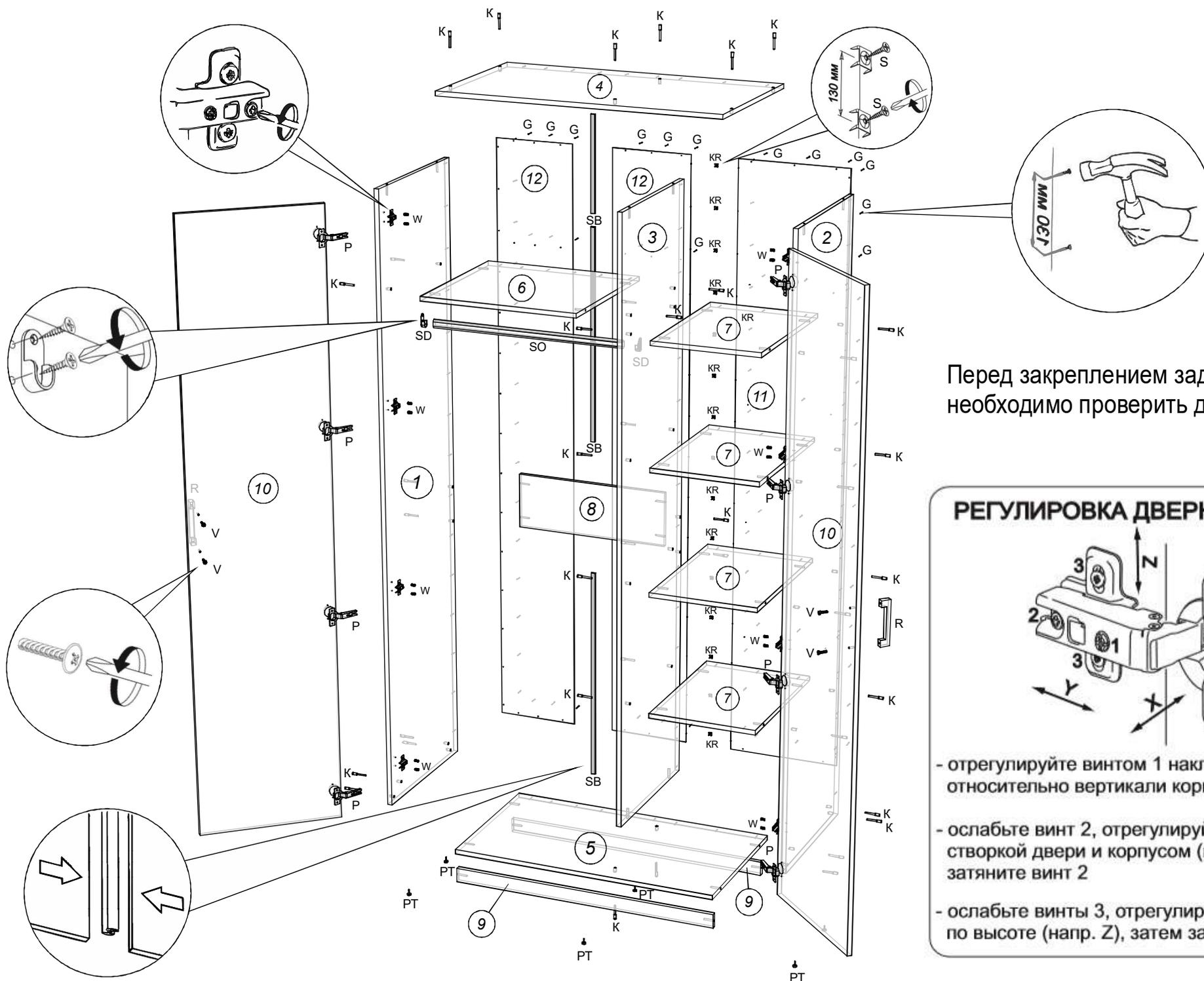
Перед закреплением задней стенки необходимо проверить диагонали шкафа !
